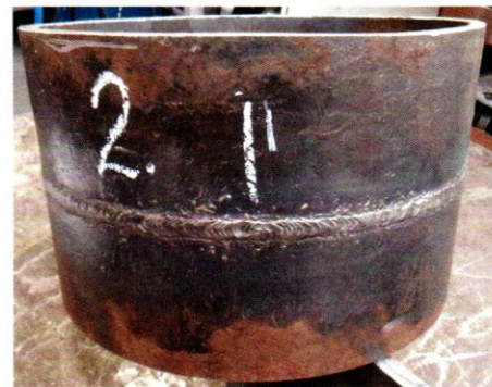
3. ábra: A meghegesztett 2. jelű csőszakasz (külső átmérő 406,4 mm)
