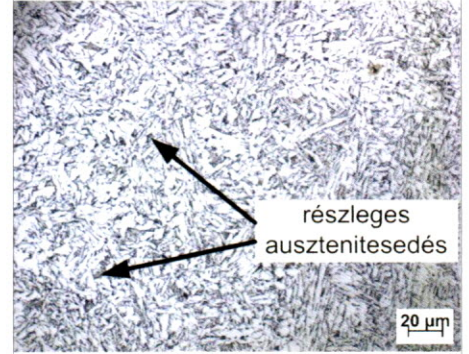
8. ábra. Az X52 jelű acél fizikai szimulációval előállított interkritikus durvaszemcsés (IK DSZ) sávja T_{max} = 1350; 775\text{ °C} , t_{9/5} = 5\text{ s} (a) és 10\text{ s} (b) esetén (marószér: 2%-os Nital).
