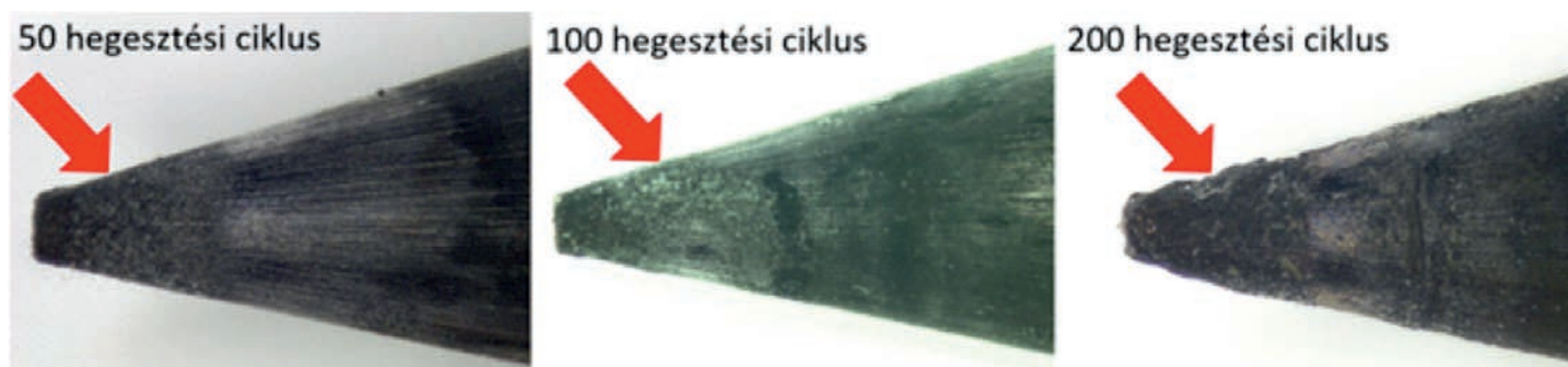
1. ábra: Oxidtartalom csökkenésének hatása az elektrodacsúcs felületi érdességére (Elektrodátípus WLa15, elektrodaátmérő 2,4 mm.)
