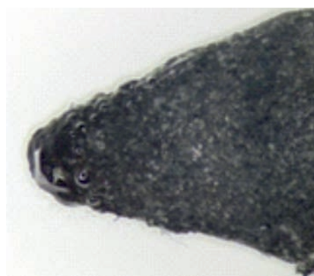
3. ábra: Az elektródacsúcs részleges megolvadása
