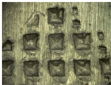
3. ábra A kötés felületén látható képlékeny alakváltozás
