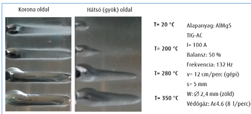
1. ábra Az előmelegítés hatása az áthegezhető lemezvastagságra
