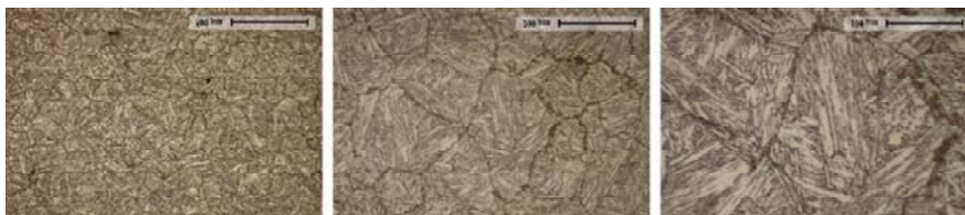
3. ábra t_{8,5/5}=15 s hűlési időhöz tartozó mikroszerkezeti szövetkép az IK-DSZ sávban (N=200x; 500x; 1000x; 2% \text{HNO}_3 )
