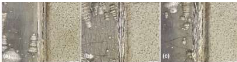
3. ábra Korrózió heterogén kötés 304- 2404 anyagok Különböző teljesítményen hegesztett a) 5200W b) 3800W c) 2000W
