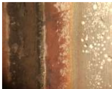
a) b) 5. ábra. Hegesztési varrat megjelenése a) hegesztés után b) 72 órás korróziós tesztelés után
