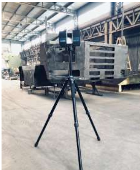
9. ábra Alváz összeállítás bemérése Laser Scanner mérőrendszerrel
