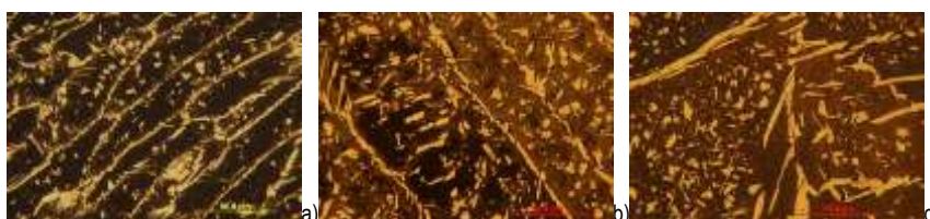
5. ábra A hegesztési sebesség hatása a varrat szövetszerkezetére autogén lézersugaras hegesztéskor. a) 2101 /1,5 mintánál; Marószér Beraha'2. Eredeti nagyítás: N=500\times a) v_{lézersugár} = 3000\text{mm/perc} b) v_{lézersugár} = 1500\text{mm/perc} c) v_{lézersugár} = 750\text{mm/perc}
