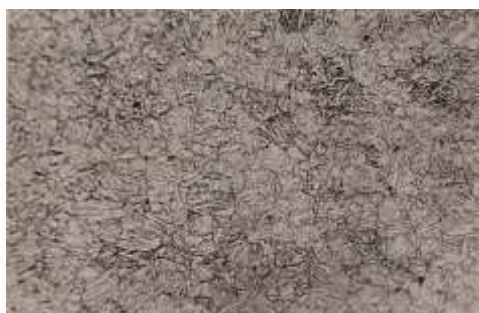
2. ábra Alapanyag mikrofélvétel N=200x
