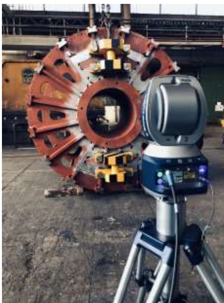
11. ábra Hegesztési deformáció feltérképezése Laser Tracker rendszerrel
