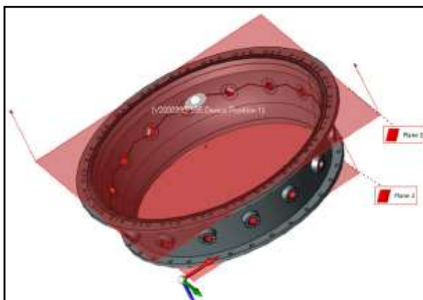
4. ábra A munkadarab CAD modellje és a mért geometriák
