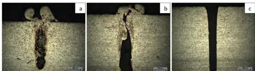
7. ábra. Korrózióálló acéllemez vágásai. (a) 35 vágás, (b) 41 vágás, (c) 43 vágás. N_{\text{erdeti}}=100x Marószers: királyvíz
