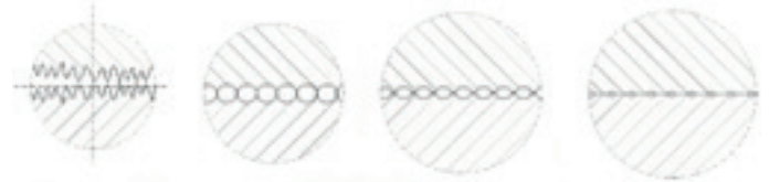
6. ábra: A felületi érdességi profil ellipszis barázdáinak közelítése és modellezése
