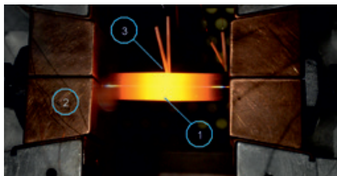
1. ábra: Diffúziós hegesztési kísérlet a Dunaújvárosi Egyetem Gleeble 3800 mérőcellájában
