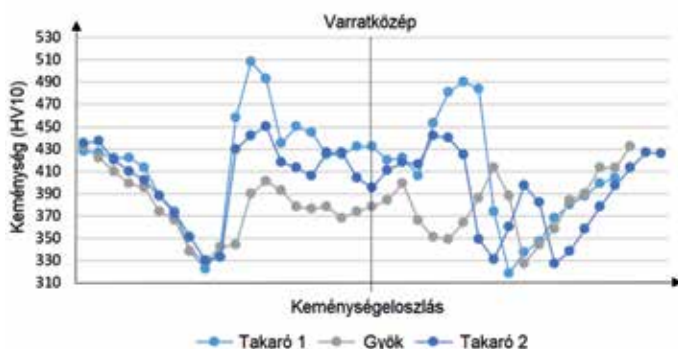
7. ábra: Keménységeloszlás a Böhler Union X96 hozaganyaggal készített kötés esetén
