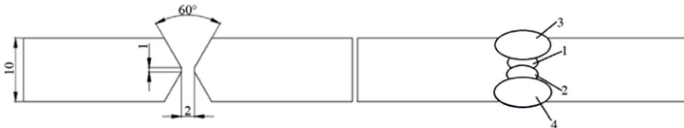
2. ábra: A kötés kialakítás és a varratsorok sematikus ábrája
