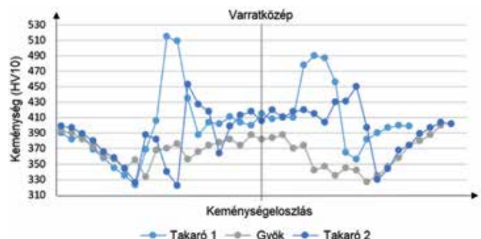
8. ábra: Keménységeloszlás a Böhler alform 1100 L-MC hozaganyaggal készített kötés esetén
