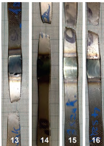
7. ábra: Elszakított FSW-ett 13. 14. 15. és 16. minták
