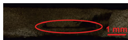
9. ábra: 15. számú FSW-ett minta mikroszkópi képén látható anyagáramlási hiba a varratban
