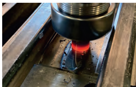
5. ábra: Bedöntött szerszámmal és 1400 1/min-es fordulatszámmal végzett kavarási dörzshegesztés folyamata
