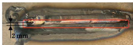
4. ábra: Hibás FSW-ett varrat (5. számú)
