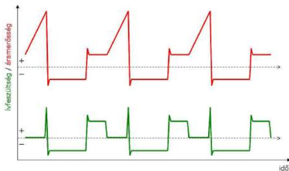
Cold Weld rövidzárlatos anyagátmenettel
