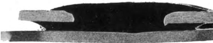
■ MIG-Lötverbindung Die Festigkeit wird durch die Kapillarwirkung um ein Mehrfaches erhöht
