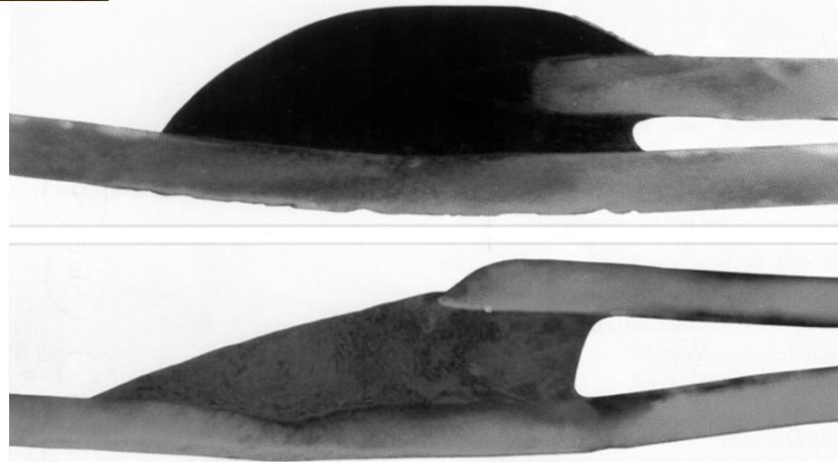
Querschliffe von MSG-Lötverbindungen an Karosserieblechen ( $s=0,8\text{mm}$ ) mit unterschiedlichen Spaltbreiten.
