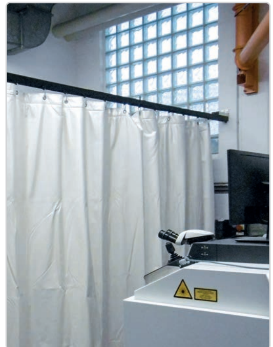
Laser Schutzvorhang mit Laufschiene
