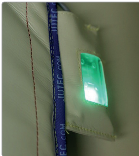
Status-LED grün - Sicherheitskreis geschlossen.
