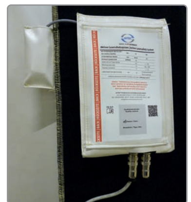
Abschaltelektronik auf laserabgewandter Seite positioniert
