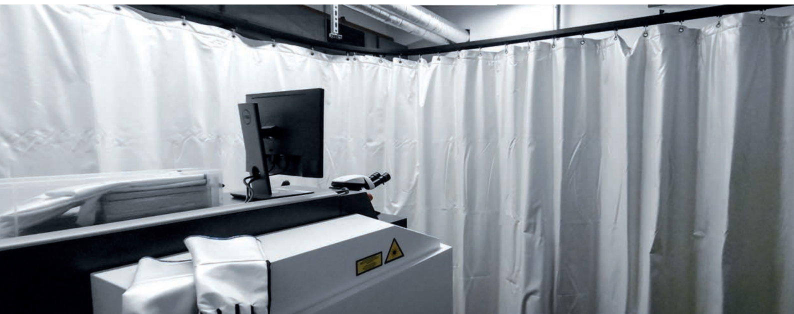
Laserschutzvorhang mit Lasertextil ML-1
