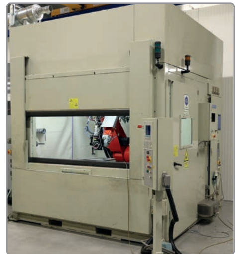
Roboterzelle, ausgelegt für niedrige Laserleistungen. Durch das aktive Laserschutzsystem von JUTEC nun auch nutzbar für sehr hohe Laserleistungen und automatisierten Betrieb.
