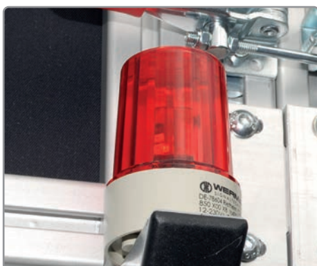
Warnleuchte zur Signalisierung des Betriebszustands
