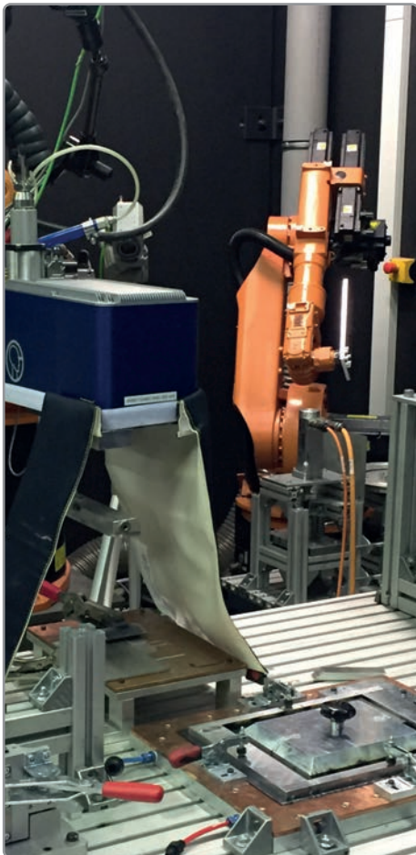
An einem Scankopf montierter Schutz gegen Streustrahlung.
