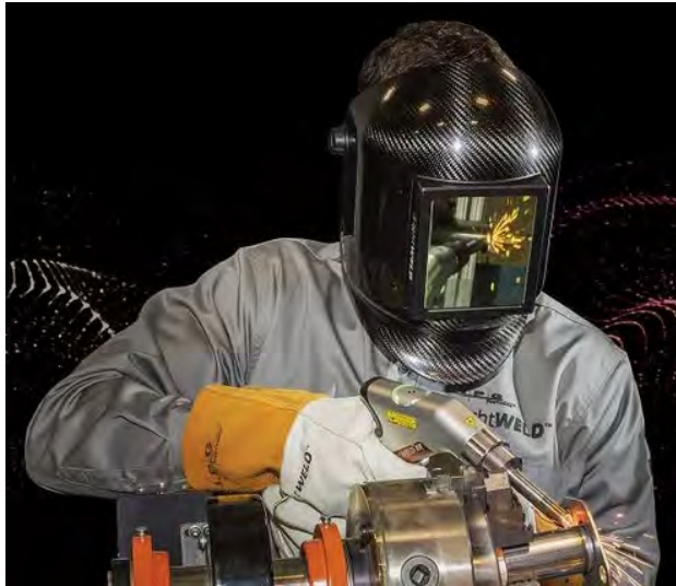
3. ábra Kézi lézeres hegesztő biztonságos egyéni védőfelszereléssel
