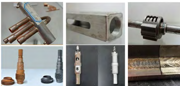
4. ábra Kézi lézeres hegesztési és felülettisztítási alkalmazások [10]
