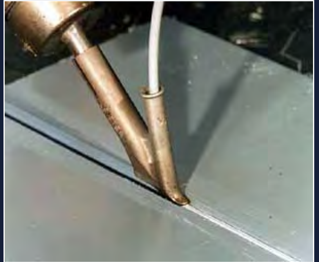
Kézi forrógázos gyors (húzó) hegesztés
