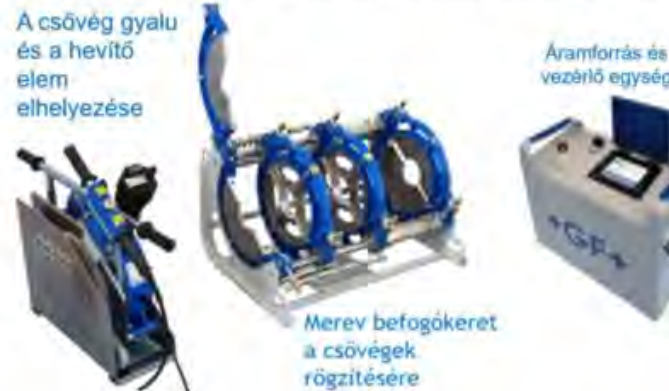
5.9. ábra Korszerű hevítőelemes tompahegesztő berendezés a hegesztési folyamatok gépesítéséhez (Forrás: Georg Fischer Piping System Ltd.)
